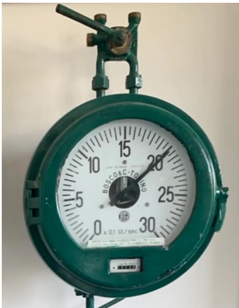
Testa di un venturimetro della seconda metà del '900, fotografie di Virginia Recanati -ogni diritto riservato-
